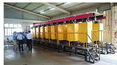
染色工場電解処理装置
